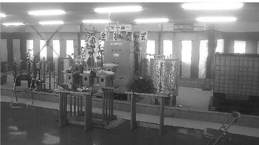
精製に水を使わないBDFプラント 農と連携した取り組みの展開に期待です
